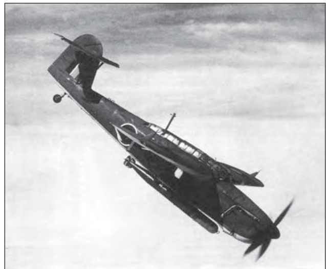
7. ábra. A Fairey Barracuda-t már 1937-től gyártották, de a Swordfish-eket csak 1943-tól kezdték el leváltani ezekkel a korszerűbb gépekkel. Szintén torpedóvető feladatra volt tervezve. A szárny felett kétoldalt látható a fedélzeti radar antennája, amely a hajók felderítésében nyújtott segítséget
