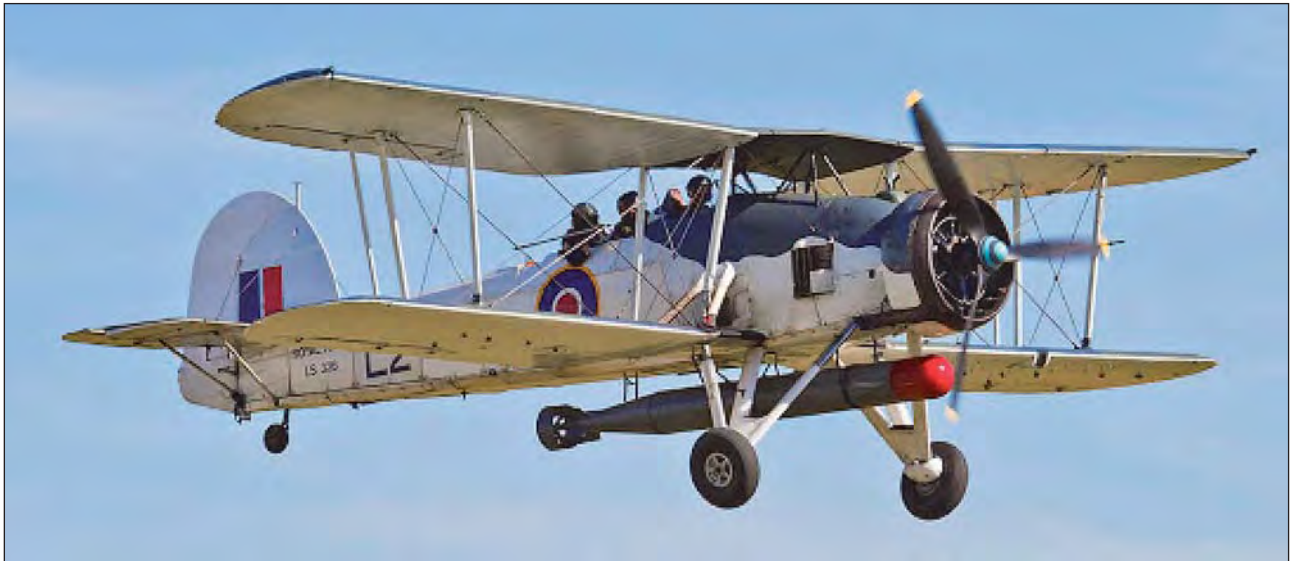
4. ábra. A vászonborítású, kétfedelű Fairey Swordfish torpedóvető repülőgép 224 km/h sebességével már a háború kezdetén sem számított korszerűnek, mégis olyan fegyvertény fűződik a nevéhez, mint a BISMARCK német csatahajó elsüllyesztésében való részvétel 1941-ben. A gép előnye a kis fel- és leszállósebesség volt. (A fotón felújított példány látható)
