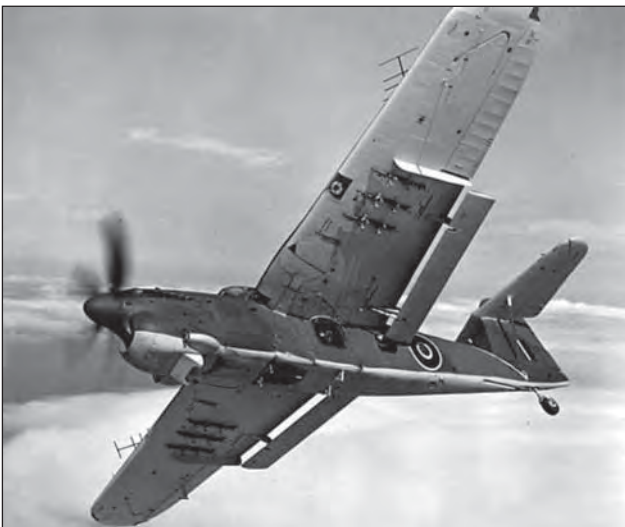
7. ábra. A Fairey Barracuda-t már 1937-től gyártották, de a Swordfish-eket csak 1943-tól kezdték el leváltani ezekkel a korszerűbb gépekkel. Szintén torpedóvető feladatra volt tervezve. A szárny felett kétoldalt látható a fedélzeti radar antennája, amely a hajók felderítésében nyújtott segítséget
